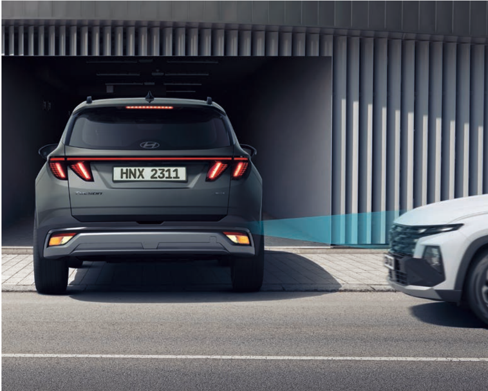
Асистент запобігання зіткненню при русі заднім ходом (RCA-R) Попереджає, якщо під час руху заднім ходом з'являється загроза потенційного зіткнення з перешкодами чи пішоходами позаду, і автоматично гальмує, коли зіткнення стає неминучим.
