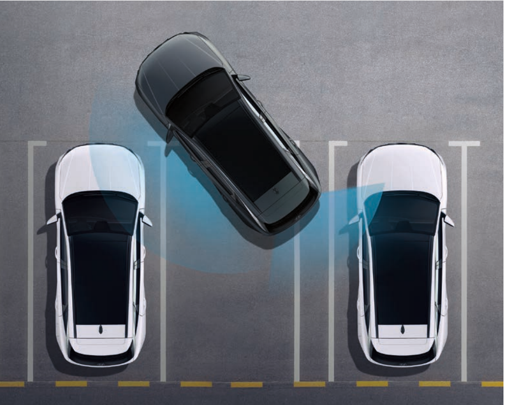
Попередження про безпечну дистанцію при паркуванні (PDW) Паркувальний асистент попереджає про зіткнення з об'єктами навколо автомобіля при русі на низьких швидкостях.
