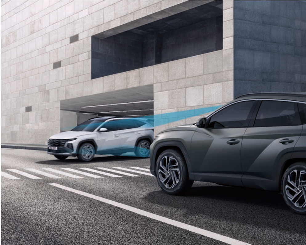
Асистент запобігання зіткненням при повороті на перехресті (FCA-JT) Скануючи дорогу за допомогою радару та камери, система автоматично гальмує, коли виявляє раптову зупинку автомобіля попереду або пішоходів і велосипедистів на дорозі. При повороті ліворуч на перехресті система гальмує, якщо є ризики зіткнення.
