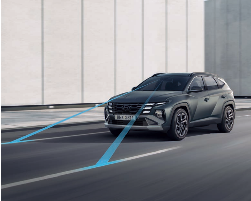
Асистент попередження про виїзд з полоси руху (LKA ) Відстежуючи лінії розмітки дороги за допомогою передньої камери, LKA запобігає ненавмисному виїзду зі смуги руху.
