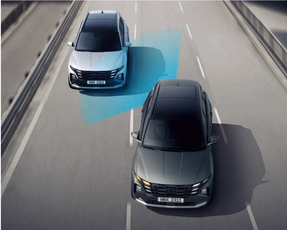
Асистент запобігання зіткненню з автомобілем в «сліпих» зонах (BSA) Виявляє транспортні засоби позаду в сліпих зонах і запобігає ризику зіткнення під час зміни смуги руху або виїзду з паралельних місць паркування, вмикаючи попереджувальний сигнал та активуючи автоматичне гальмування.
